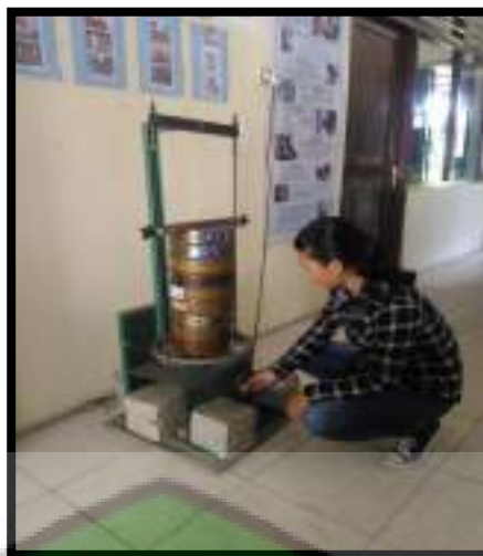
Gambar 4.2 Uji Saringan Pada Sampel Pasir
